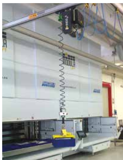
Выносная рамка с сенсорной рукояткой и в комплекте с устройством для регулировку центра тяжести.
